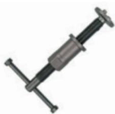
Praska do tłoczków hamulcowych - lewa
