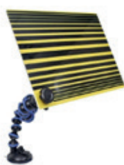
Tablica refleksyjna do usuwania wgnieceń w karoserii
